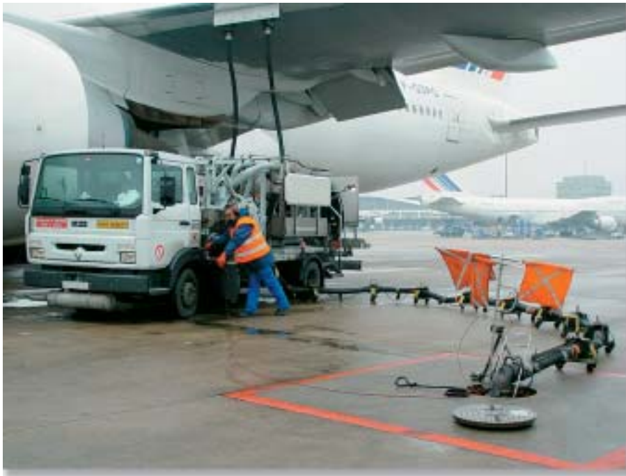
Flexible hydrant raccordé sur une bouche hydrant
