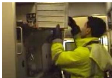
Photo 4 : la conception actuelle des « armoires » (position dans le galley avion, emplacement des poignées, etc.) entraîne des contraintes fortes pour les poignets, coudes et épaules. L'analyse du geste et des stratégies d'économie posturale déployées par les agents permettent de définir avec précision le besoin, notamment en ce qui concerne le positionnement des poignées sur ces contenants.
